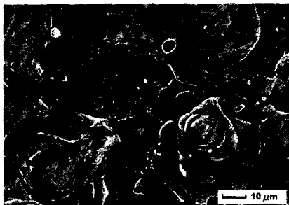
图 5 用工作液切割表面微孔洞及微裂纹形貌
