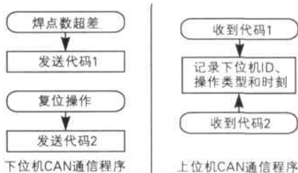
图 5 CAN 通信程序流程
