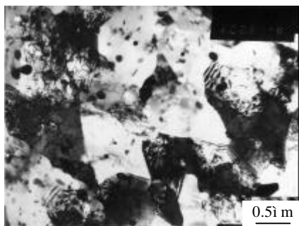
图 4 三向多道次锻件的 TEM 组织 (始锻温度 440 °C, \epsilon=4.2 )
