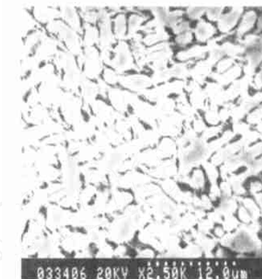
图 8 RW22 试样熔覆层的组织 (SEM)
