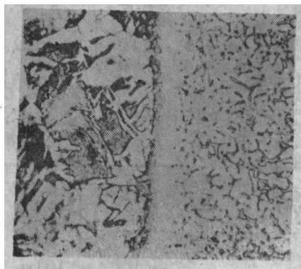
图2 20号渗铝钢焊缝组织(×300)
