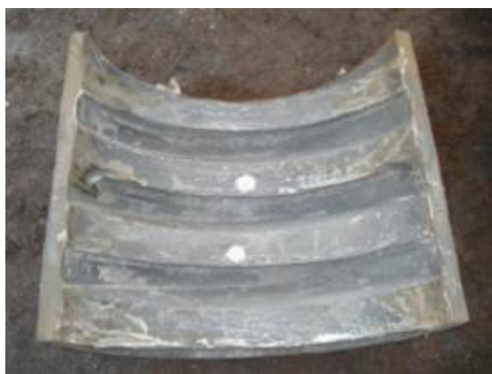
图 1: R340×长 590×高 290 mm，壁厚 40-90 mm溜槽衬板产品
