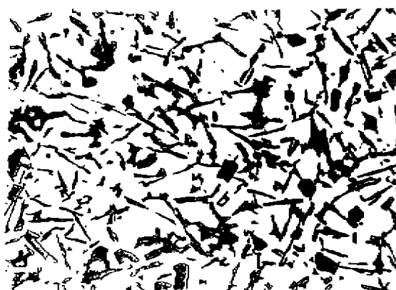
图 1 未变质 \times 200 0.5%HF 水溶液浸蚀 图 2 Na 变质 \times 200 0.5%HF 水溶液浸蚀
