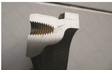
图5 热节部位的缩气孔
