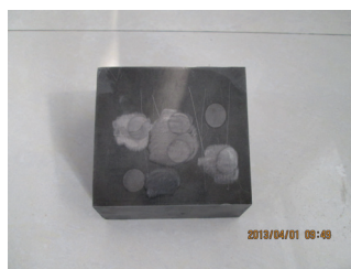
图 7 硬质合金与基体的冶金结合
