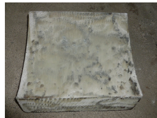
图 3 组合式硬质合金溜槽衬板
