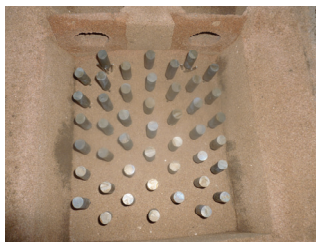
图 2 硬质合金在铸型内的分布
