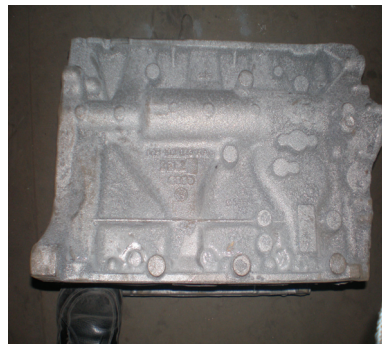
图 6 煤粉砂铸件表面质量
