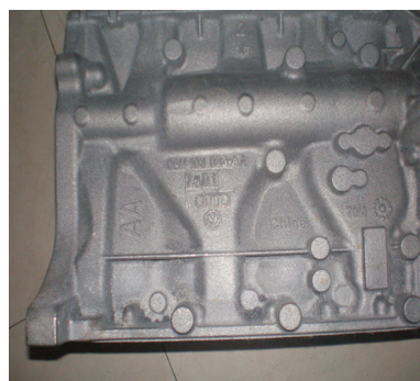
图 8 添加剂砂铸件表面质量
