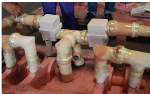
图 3 过滤器的常见连接方法
