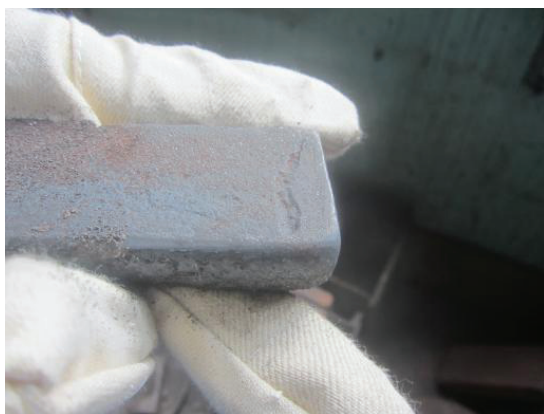
图5 恶化试验三角试块表面形成的缺陷形貌
