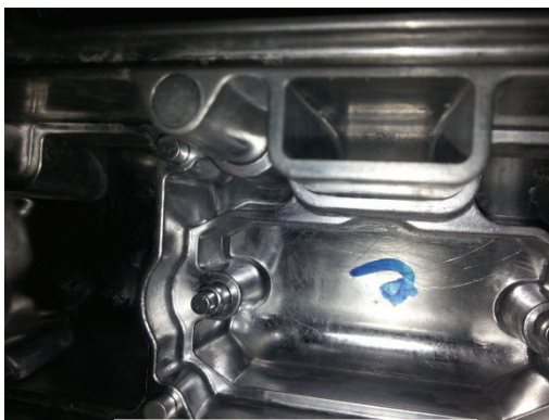
图5 铸件无收缩裂纹
