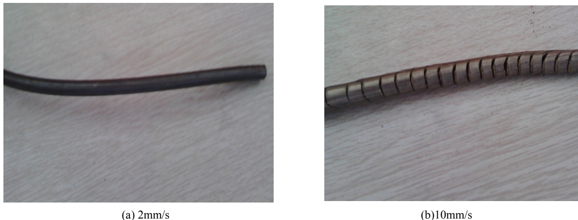
图2 不同挤压速度下的镁合金管材
