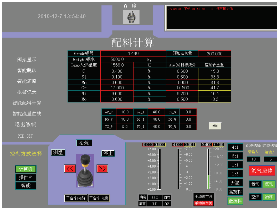
图 3 AOD 精炼炉配料计算组态界面
