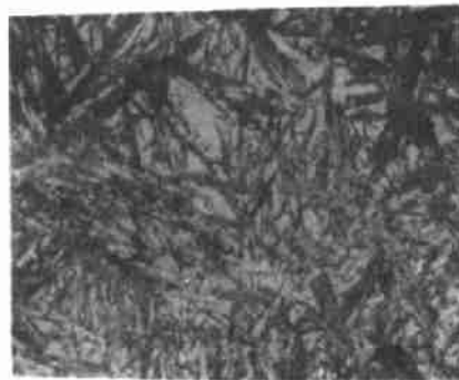
d. 450 °C 预热+200 °C 后热熔合区 ×400
