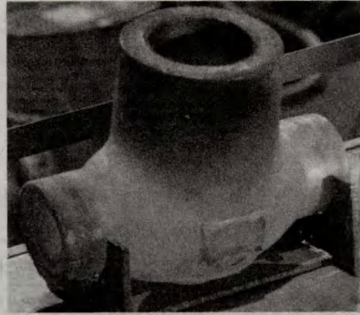
图7 在40 MN/64 MN多向模锻液压机上一次成形的20钢76.2 mm(3 in)阀体
