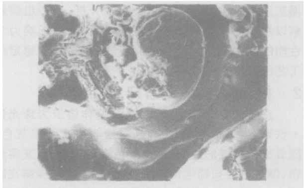
图 5 疏松二次电子图像(×200)
