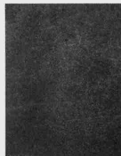
图12 铸件表面“黑皮” 图13 “黑皮”放大照片 形状小麻坑(见图14),严重恶化铸件表面质量。
