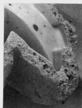
图5 型壳表面和断面上的硅酸铁“墨点”
