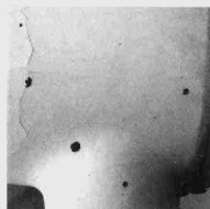
图2 焙烧后型壳表面出现的“墨点”
