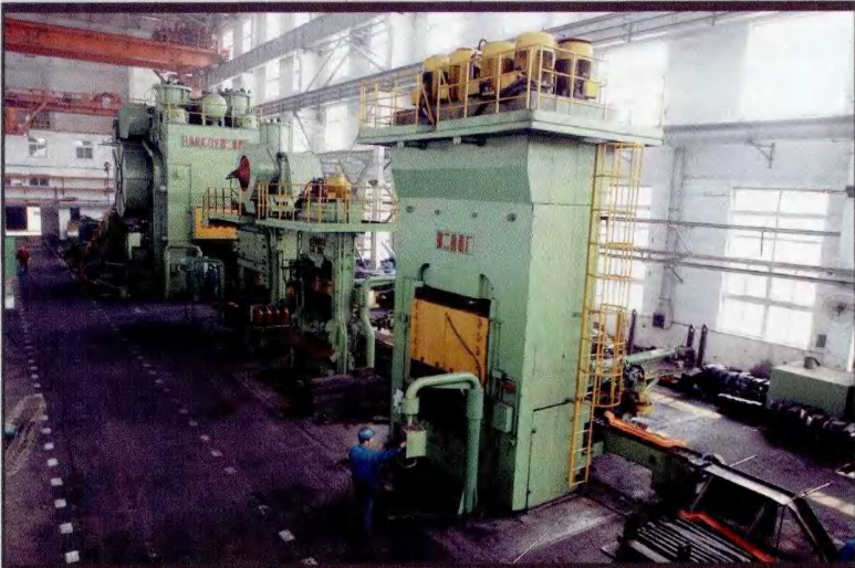
12500t自动生产线，节能节材效果明显
