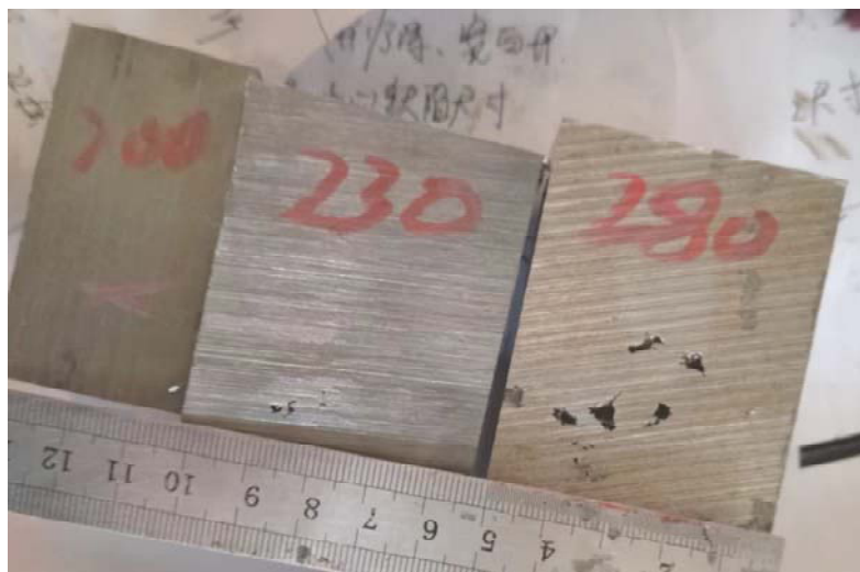
图 8 锯切后心部缺陷形貌及尺寸
