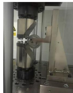
图15 齿轮齿根弯曲疲劳试验
