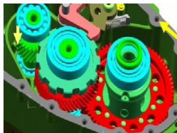
图10 博格华纳的电动汽车减速器中的润滑油路
