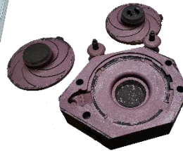
叶轮设计 砂芯 砂型和成品
