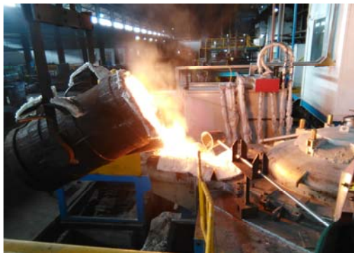
图 3 铁液倒进保温炉时同步进行的随流孕育过程
