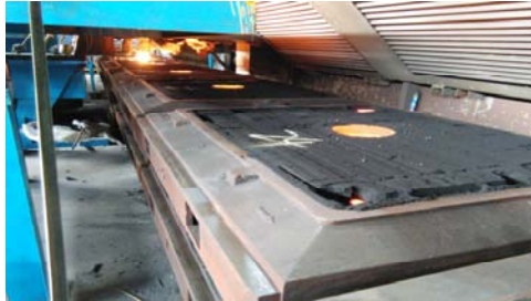
图 2 浇注后无金属液抛洒的上箱表面图
