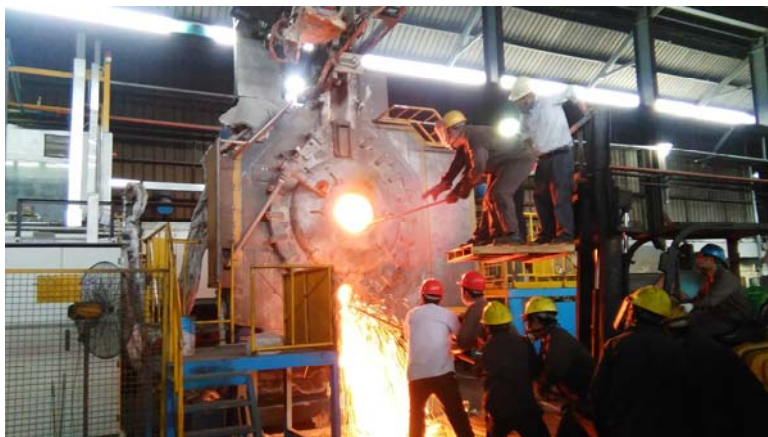
图 4 炉体清渣过程
