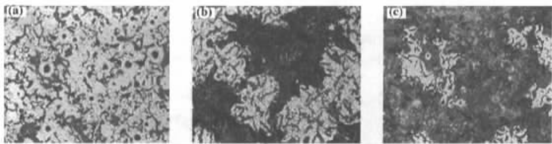
图3 不同锰含量的蠕墨铸铁( CE=4.12\% )组织(a- 0.15\%Mn ;b- 0.8\%Mn ;c- 1.46\%Mn ) \times 100
