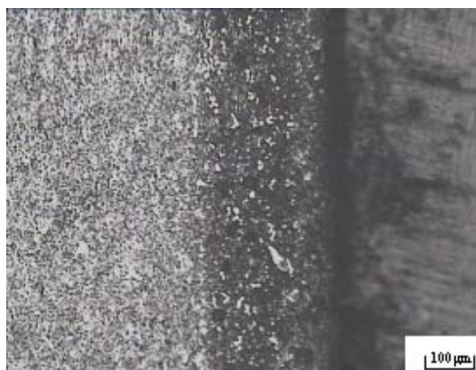
图 8 磨削烧伤层组织 Fig.8 Microstructure of grinding burn
