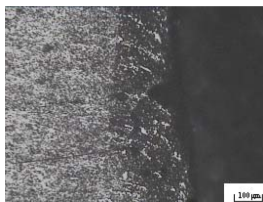
图 9 不良铣削层组织 Fig.9 Microstructure of improper milling
