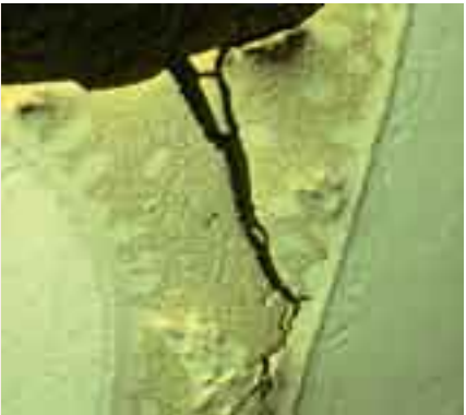
图2: 铜/不锈钢钎焊点的抛光截面。DIC, 100x.
