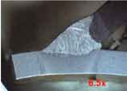
碳钢中贯穿MIG焊接件的研磨及浸蚀后宏观截面，采用4%Nital试剂进行浸蚀。明场，6.5x
