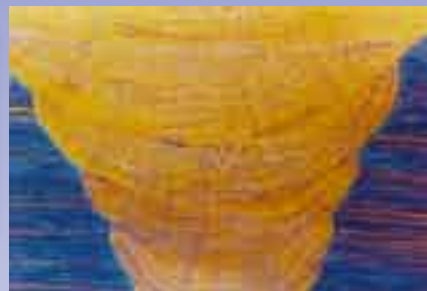
多道次奥氏体不锈钢焊接件抛光及着色浸蚀后的截面。根据Lichtenberger和Bloech方法进行着色浸蚀。明场，6.5x
