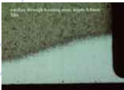
抛光与浸蚀后的截面显示出热损伤的渗透深度。明场，50x
