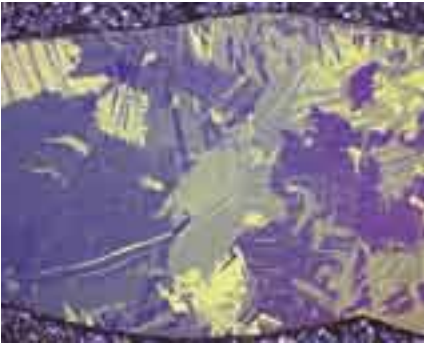
焊接区域。一级钛中的全熔透焊接件机械抛光截面。焊接件显微组织含有α相魏氏组织。带有灵敏调色片(λ 1/4-plate)的偏振光，50x
