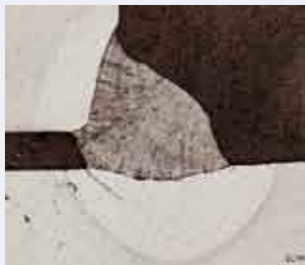
低合金钢角焊接件下的热影响区裂纹。 明场, 5x
