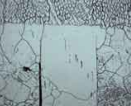
相同的材料。焊接件中的显微组织包括初晶固溶体及细小未溶相。截面显示：基材中熔合面附近基材出现显著的晶粒粗化。明场，10x
