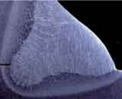
深熔深带焊碳钢的宏观截面。截面采用5%的硝酸化乙醇腐蚀液进行浸蚀。明场，2.5x
