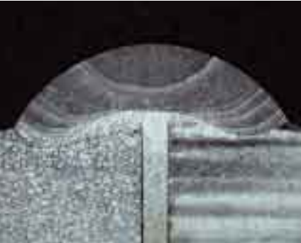
Inconel625合金的微脉冲钨极惰性气体保护焊试样的机械抛光与电解浸蚀截面，采用10%的草酸进行浸蚀；电压为10伏特，持续10秒。明场，2.5x
