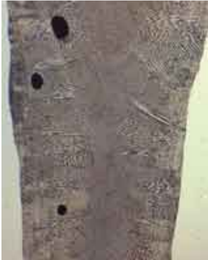
镍基合金的电子束焊接件横截面显示出焊接柱状显微组织及少数分散气孔。明场，50x
