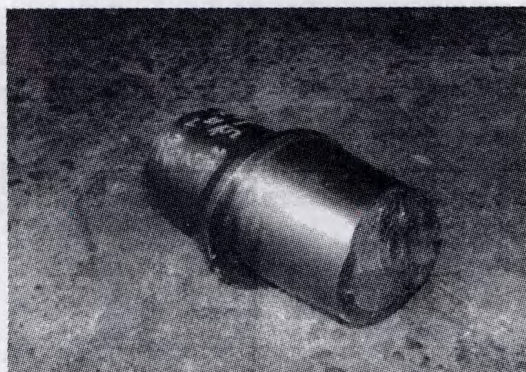
图 1 偏心销断裂残体照片 1
