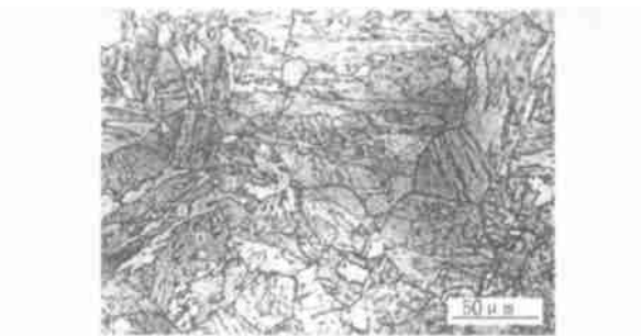
图 2 宝钢 T23 耐热钢管(成品)室温组织
