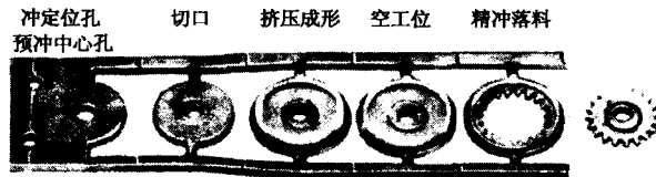
图 11 棘齿轮成形工艺过程
