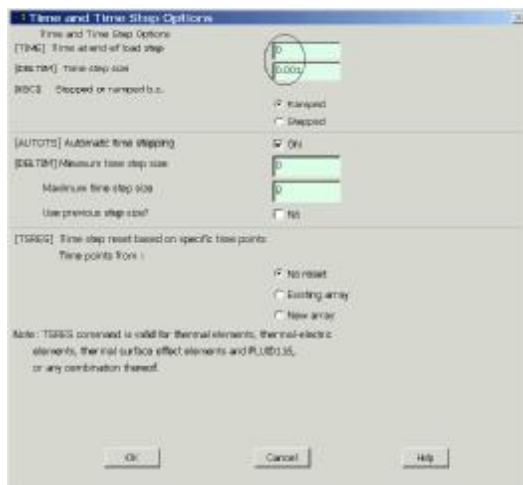
图 5-38 设置第一载荷步
