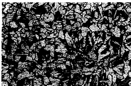
图 18 1080 °C 正火后的基材组织 (晶粒度 7 级(4% 硝酸酒精))
