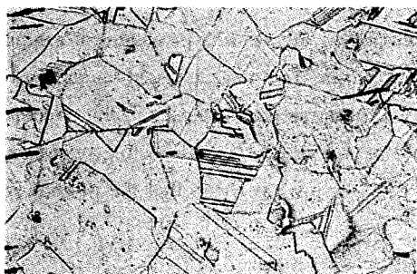
图 19 固溶 + 回火后的复材组织 (10% 草酸电解)
