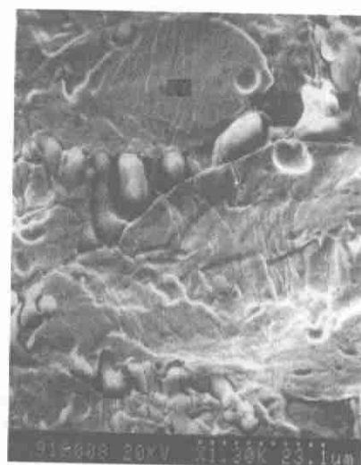
b. 夹杂物1300X电镜下形貌
