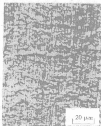
图 2 过厚油膜轧制铝板表面形貌
