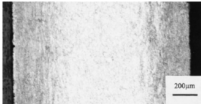
图 1-6 包含表面的 UFF（黑色）和心部的粗晶粒（亮）的分层组织量边界
