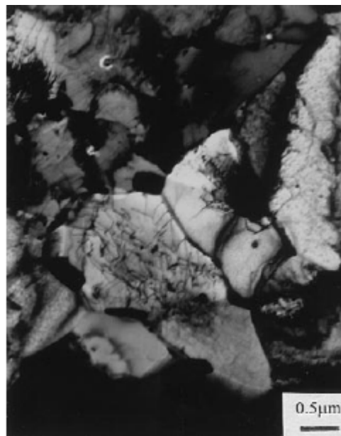
图 1-8 TEM 显示铁素体平面晶界和低的位错密度
