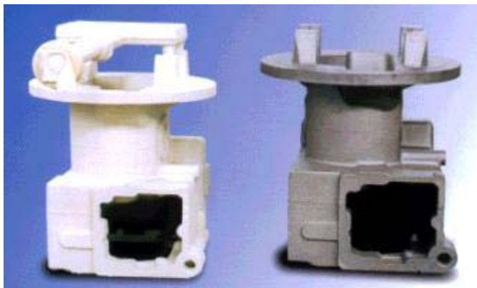
图 2 消失模模型和铸件
