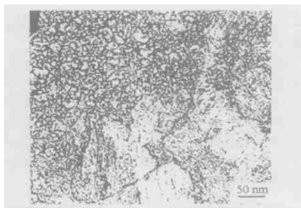
图2 34CrNi3MoV 钢调质处理后的混晶组织
