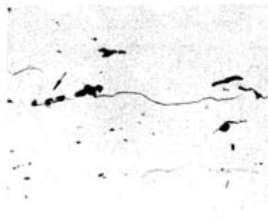
图 5 LD2 合金中的机械阻碍物对晶界迁移的阻碍(箭头所指) 530×
